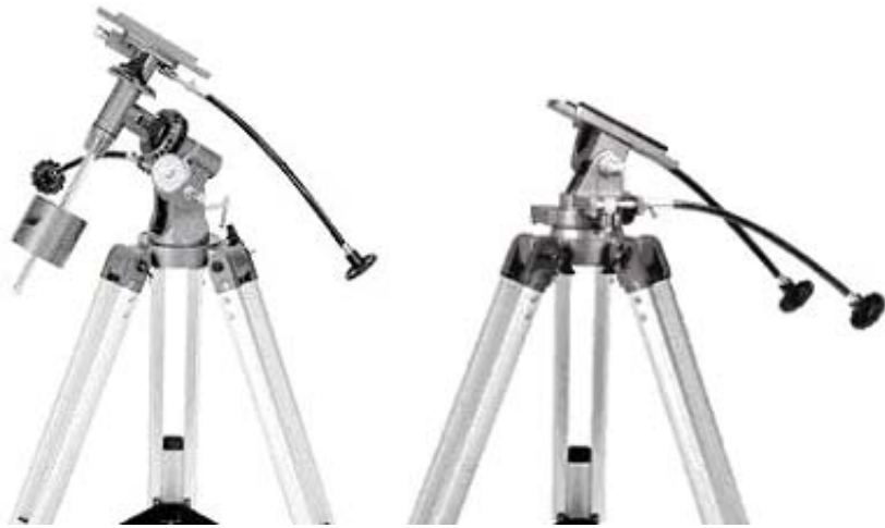
Рис. 8. Екваторіальне (а), азимутальне (б) і монтування.
